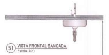
BANCADA EM GRANITO ANDORINHA COM RODA BANCA DE \* 4cm COM CUBA DE AÇO INOX (460x300x150mm), INCLUSIVE SIFÃO, VÁLVULA E ENGATES CROMADOS, TORNEIRA CROMADA DE MESA PARA PIA, BICA ALTA, ACIONAMENTO POR ALAVANCA DE COTOVELO.
